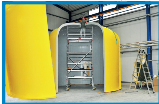
Mobiler Wetterschutz für Anlagentechnik auf den SIEMENS-Converter-Plattformen BorWin beta, HelWin alpha (Gewicht: 1.5t, Maße: 5m Höhe und 4,8m Durchmesser) mobile weather protection for installation engineering on deck of the SIEMENS converter platforms BorWIN beta & HelWIN alpha (weight: 1.5 tons, dimensions: 17ft height and 16ft diameter)
